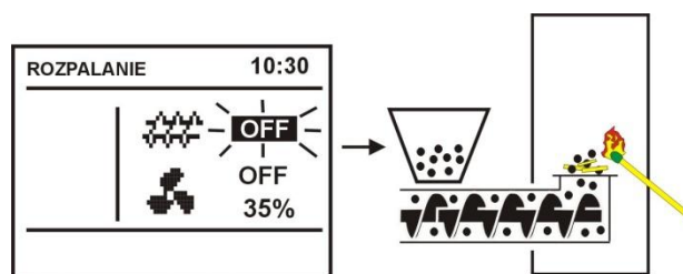
Rys. 2 Wyłączenie podajnika w rozpalaniu
