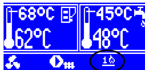
Сигнализация режима РОЗЖИГ и номера попытки.
