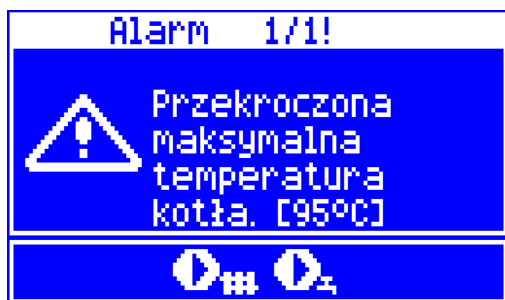
Rys. 29 Widok alarmu przegrzania kotła.
