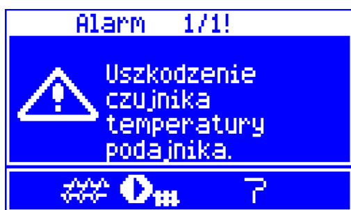
Rys. 31 Widok alarmu „uszkodzenie czujnika temperatury podajnika”.
